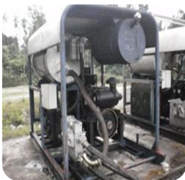
Hos Hidraulik Pam Bergerak Sering Mengalami Kekerapan Kebocoran
